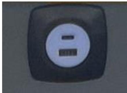
Sollten die USB-Ladebuchsen für den Fahrgast nicht leicht zu erkennen sein, muss eine Kennzeichnung erfolgen.
