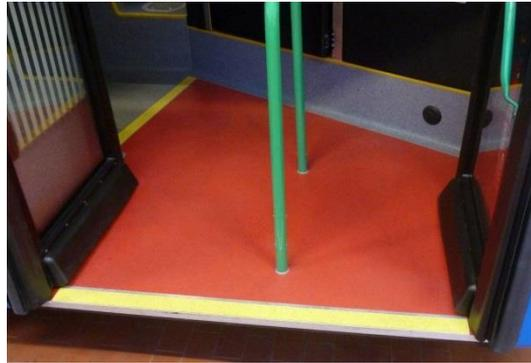
**Podestkanten** sind signalgelb (RAL 1003) zu markieren. Alternativ kann bei den Podestkanten auch der Farbton verkehrsgelb (RAL 1023) verwendet werden.
